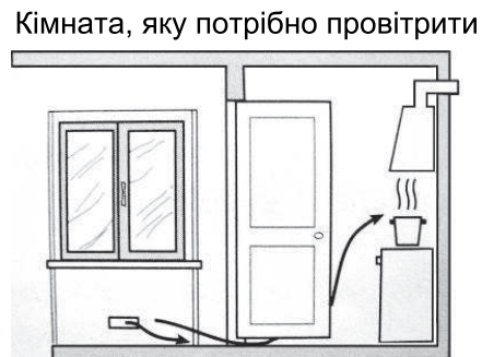
Збільшення вентиляційного отвору
